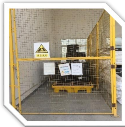
圖：對有害廢棄物進行隔離存放，存放點懸掛危險廢物標識
